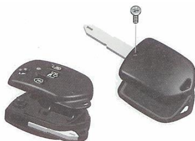
شکل ۲-۸ باز کردن درپوش سوئیچ
