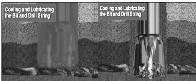
شکل ۱-۳- خنک کردن و روان کاری مته و رشته حفاری
