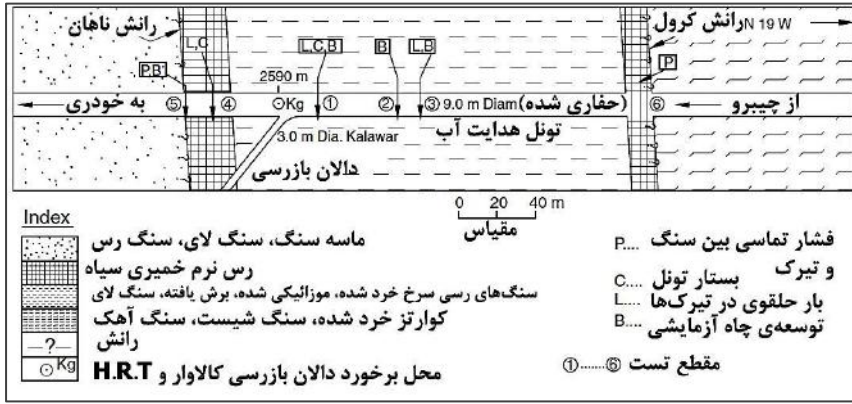
شکل ۲۰-۸- موقعیت‌های مقاطع آزمایش و جزئیات آن برای تجهیزسازی ناحیه رانش داخلی در کالاوار
